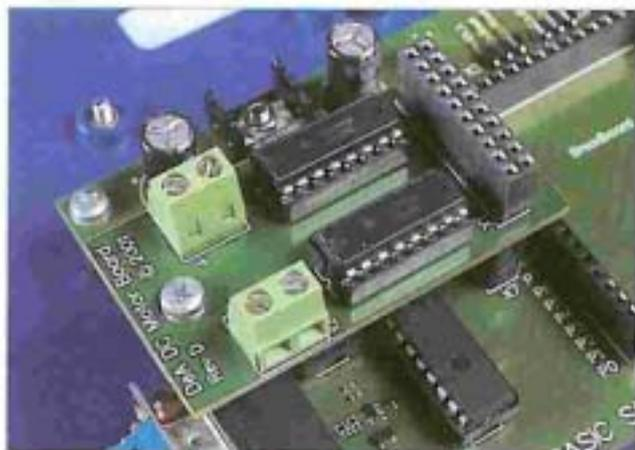
● Ecco come apparirà la scheda di controllo motori una volta che l'avrai montata sulla scheda madre. Il collegamento tra le due schede si realizza con la connessione tra il bus di espansione X7 della scheda madre e quello X1 della scheda di controllo motori.
