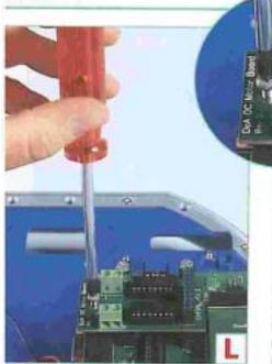
L Assicura infine la scheda di controllo motori alla scheda madre: posiziona la vite precedentemente rimossa nel distanziale attraverso il foro della scheda di controllo motori e avvitala con il cacciavite a stella.
