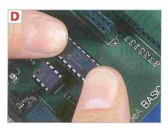
D Ora puoi bloccare i piedini del microcontrollore tra i contatti dello zoccolo, esercitando una pressione uniforme verso il basso. E Ecco come appare la scheda madre del tuo robot dopo il corretto posizionamento del microcontrollore.
