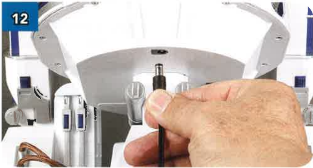
12 Collega l'alimentatore a una presa della corrente e inserisci il jack nella presa di R2-D2. Accendi R2-D2 e attendi un paio di secondi, poi spegnilo.
