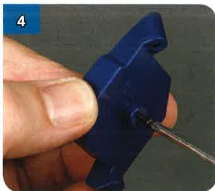
... e fissalo con una vite nera autofilettante da 2,3x6 mm.
