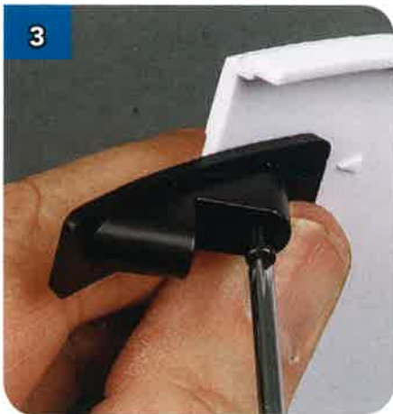
3 Fissa il connettore al perno usando una vite nera autofilettante da 2,3x6 mm.
