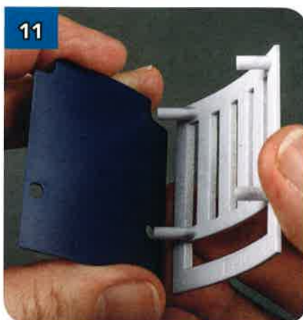
11 Allinea i quattro perni sul retro di BP-14 con i fori di BP-15...
