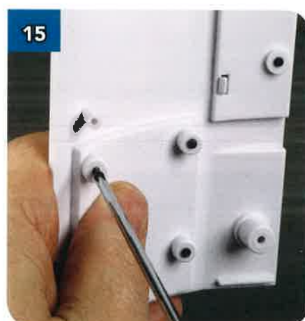
15 Fissa BP-14 usando quattro viti nere autofilettanti da 2x6 mm.
