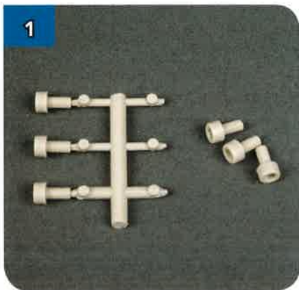
1 Stacca tre viti a brugola dalla materozza (le altre tre sono di ricambio).
