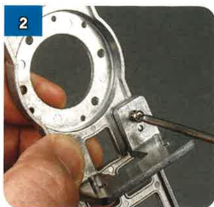
2 Avvita una vite da 2,5x6 mm in un foro superiore di BF-11 per fissarlo a BF-10.
