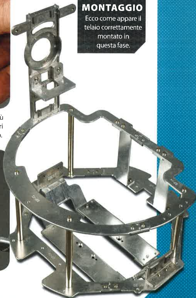
7 Infilà due viti da 2,5x8 mm nei fori del telaio per fissarlo a BF-10.
