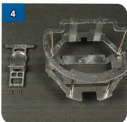
4 Prendi il pezzo appena montato, recupera il telaio del corpo della Fase 75 e due viti da 2,5x8 mm.
