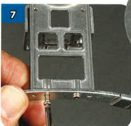
7 Infilà due viti da 2,5x8 mm nei fori del telaio per fissarlo a BF-10.
