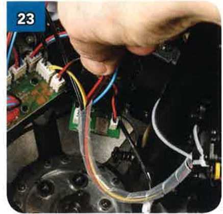
23 Posiziona i cavi tenuti insieme dall'avvolgicavo ordinatamente su un lato.
