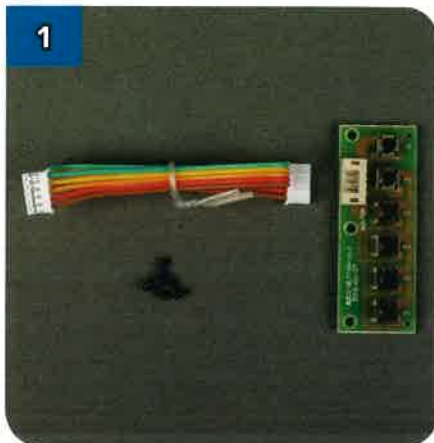
1 Prendi la scheda pulsanti, il cavo e tre viti autofilettanti da 2,3x6 mm.
