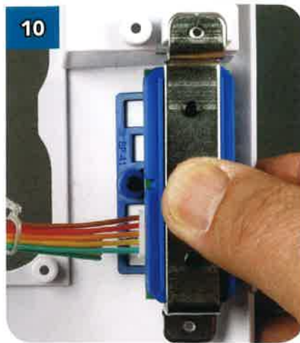
... allineando le estremità delle staffe con l'incavo nella parte superiore e il perno forato nella parte inferiore.
