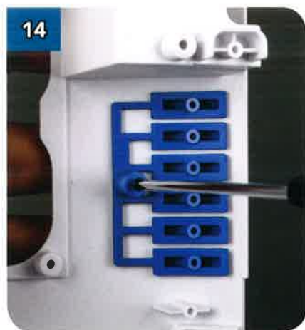
... e fissalo con una vite autofilettante da 2,3x6 mm.
