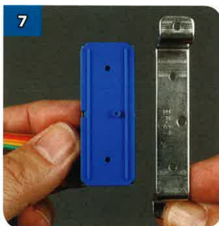
7 Allinea il supporto di metallo BF-37 con il retro di BF-36, esattamente in questo modo.
