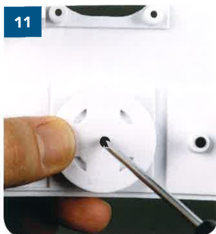
... e fissalo con una vite autofilettante da 2,3x6 mm.
