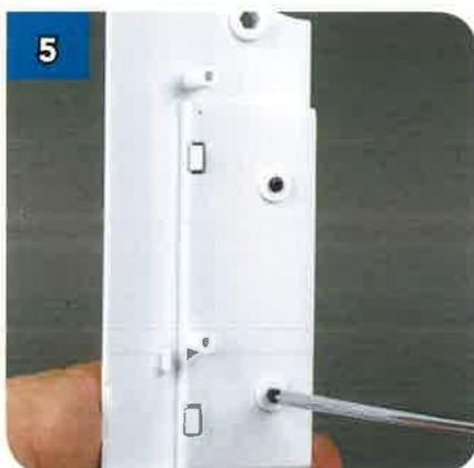
Fissala con due viti nere autofilettanti da 2x4 mm.
