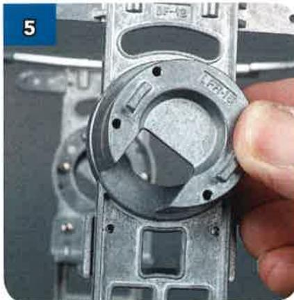
Ripeti i passaggi 2-4 per montare il secondo giunto LFR-18 alla parte BF-10, sul lato opposto del telaio.
