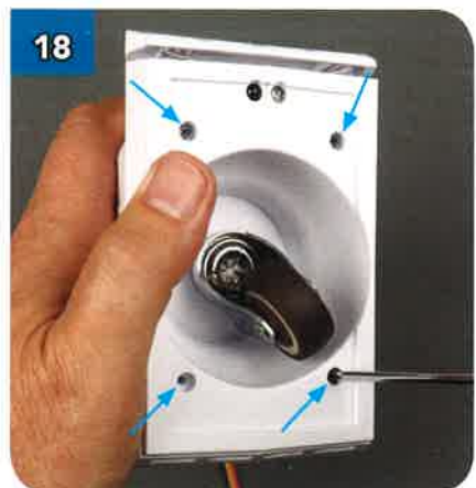
18 Fissa la placca inferiore, con 4 viti autofilettanti nere da 2,3x6 mm.
