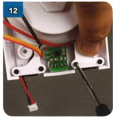
12 Ripeti la procedura per montare il fermo del microinterruttore sinistro nello stesso modo.
