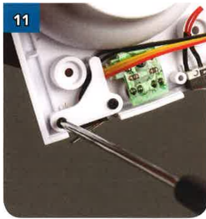
11 ... e fissalo usando delle viti autofilettanti da 2,3x6 mm.
