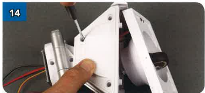
14 Assicurati che i cavi siano ben stesi all'esterno del piede e poi fissa insieme le due metà con delle viti nere autofilettanti da 2,3x6 mm...
