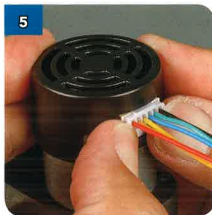
5 Infila il connettore fino in fondo alla presa.
