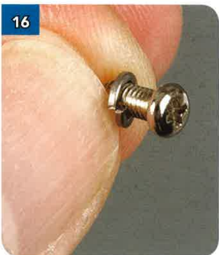
Infila una rondella su una delle viti...
