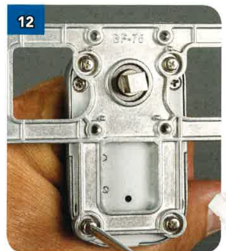
Ripeti i passaggi 9-11 agli altri tre angoli del blocco motore, quindi serra completamente tutte e quattro le viti.
