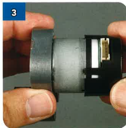
3 ... e bloccala nella sua sede come mostrato, la presa bianca deve risultare accessibile.
