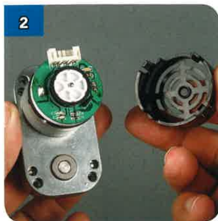
2 Allinea la copertura del motore con la scheda elettronica del motore...
