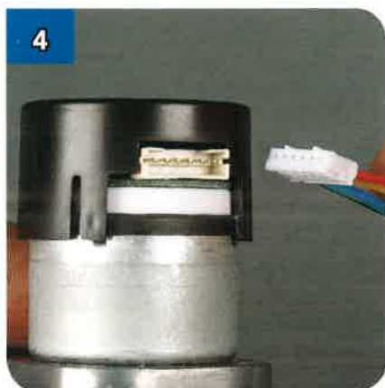
4 Prendi il connettore più grande del cavo e allinealo con la presa, in questo modo.
