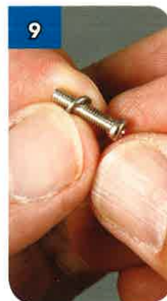
9 Infila una rondella su una delle viti...
