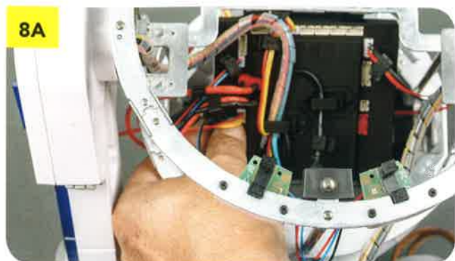
8A Inserisci il cavo con l'etichetta L.F-M nella presa corrispondente sulla scheda MCU...
