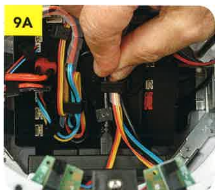
9A Infilta il gruppo di cavi dalla gamba destra sotto questo fermacavi...
