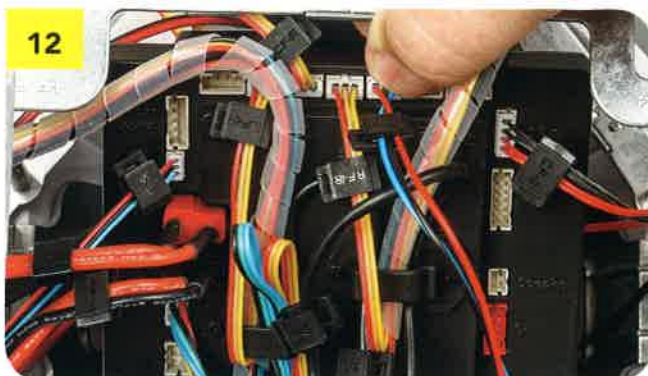
12 Dalla parte superiore del telaio, porta verso il basso il cavo con l'etichetta L.H-IR e infilalo nella sua presa sulla scheda MCU.
