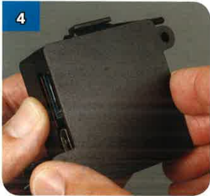
4 Tenendo ferma la parte della custodia con le fessure di ventilazione, solleva il coperchio con delicatezza...
