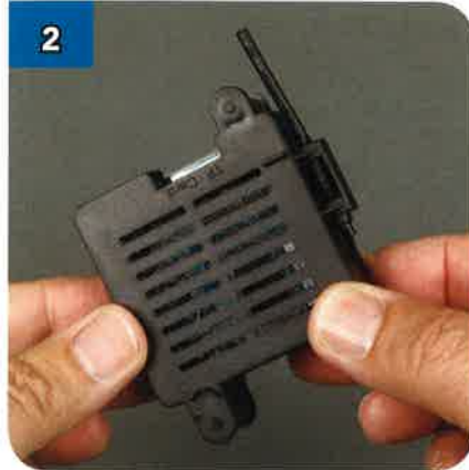
2 Rimuovi con cautela la scheda elettronica.
