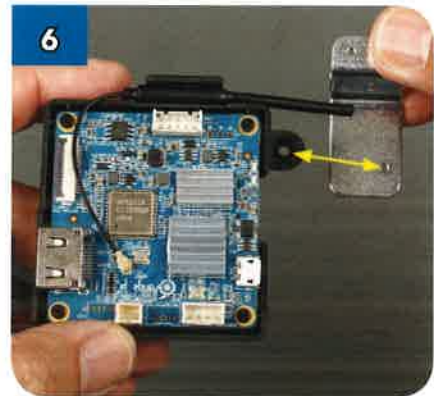
6 Prendi una delle staffe e allinea il foro indicato con quello della custodia. La staffa posizionata va sotto la custodia.
