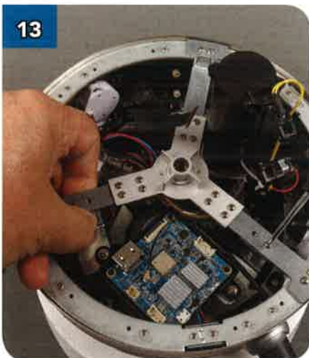
13 Tieni in posizione la scheda mentre fissi le staffe ai bracci del telaio con delle viti argentate da 2,5x6 mm...
