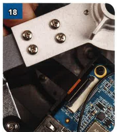
18 ... passalo sotto il braccio del telaio e inseriscilo nel connettore bianco della scheda PCB.
