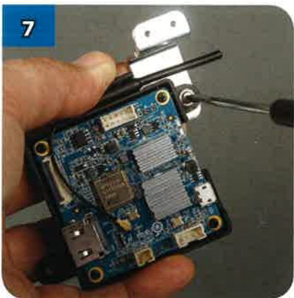
7 Avvita la staffa al perno con una vite flangiata da 2,5x6 mm.
