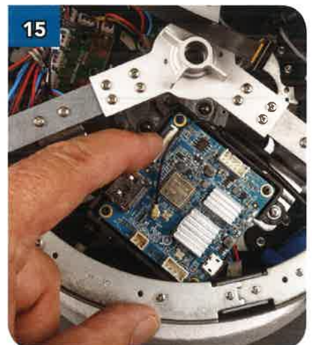
15 Accertati di aver scaricato l'eventuale carica statica accumulata (vedi Suggerimento a pagina A) e poi, aiutandoti con la punta di un dito, apri il connettore "a pettine" sulla scheda.
