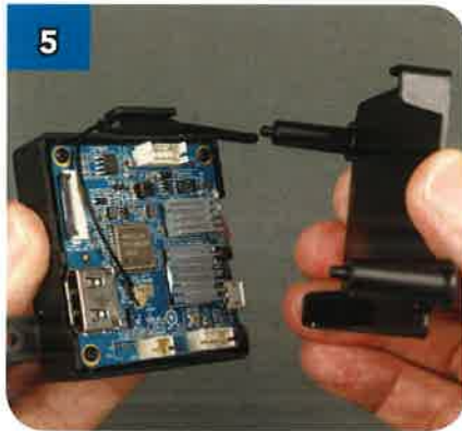
5 ... in questo modo, evitando di toccare con le mani la superficie della scheda elettronica.
