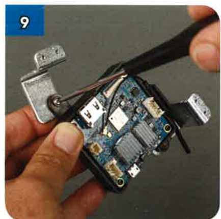
9 ... e fissala in posizione con una vite flangiata da 2,5x6 mm.
