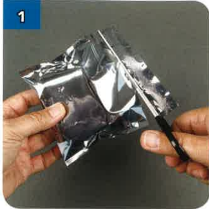
1 Estrai la scheda PCB dalla scatola di cartone in cui è custodita. Taglia con cura il sacchetto antistatico, vicino al bordo.
